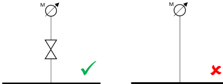
Abbildung 11: Beispiel links - Manometer ist mit einem Absperrventil von der Leitung getrennt (zulässig). Beispiel rechts - Manometer ist nicht mit einem Absperrventil von der Leitung getrennt (unzulässig).
