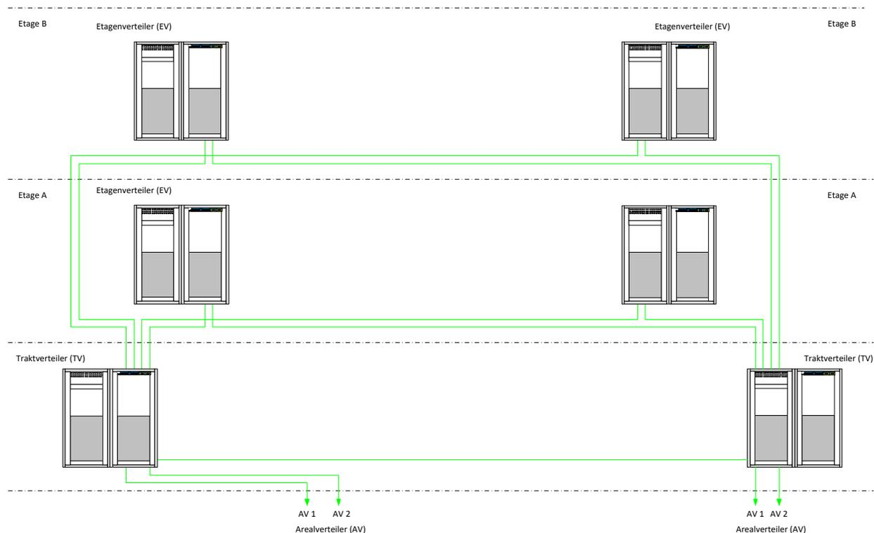
Abbildung 2: Schema Redundanz Sekundärverkabelung
