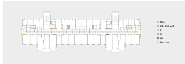
Geschoss E: Steigzonen und Horizontalverteilung
